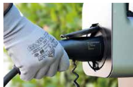
EV-TEST100: 1- und 3-phasiger Prüfadapter mit Stecker Typ 2 zur Simulation von Ladezuständen und zum Prüfen der Wirksamkeit von Schutzmaßnahmen an E-Ladestationen
